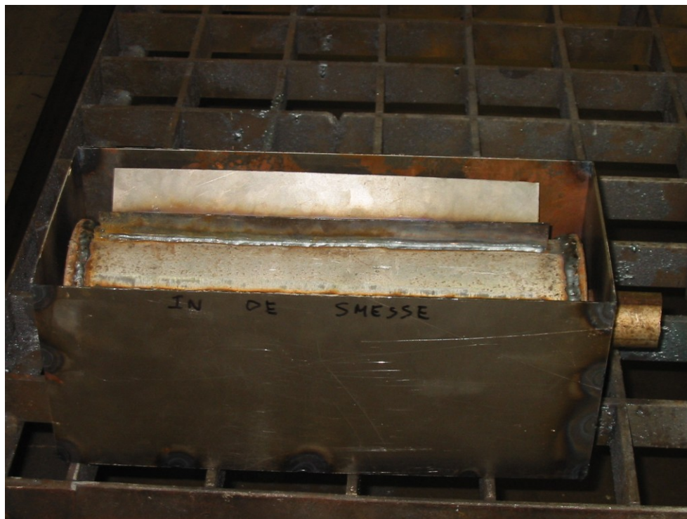
Fig. 4.7:foto warmtewisselaar uitlaatgassen
