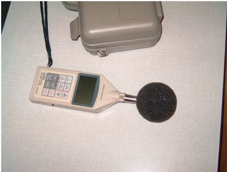
Fig. 8.1: De geluidsmeter: een Ono Sokki LA-220
